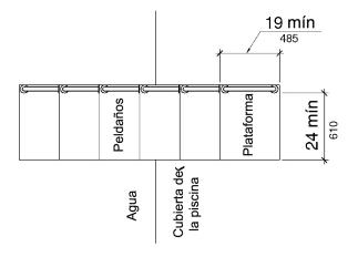
Figura 1009.5.1 Tamaño de la Plataforma de Transferencia
