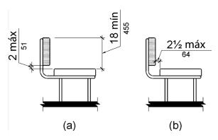
Figura 903.4 Apoyo para la Espalda del Banco
